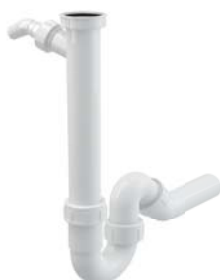
A81V-DN40 Sifon trubkový s převlečnou maticí G 6/4" × DN 40 a přípojkou Ø 18,5 mm
