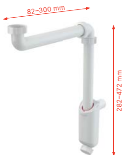
A43SL-DN32/40 Sifon umyvadlový nábytkový DN 32/40 prodloužený s převlečnou maticí G 5/4"
