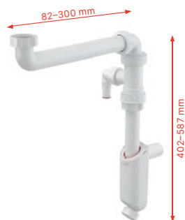
A43SLP-DN32/40 Sifon umyvadlový nábytkový DN 32/40 prodloužený s převlečnou maticí G 5/4" a přípojkou Ø 17-23 mm
