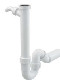
A81V-DN50 Sifon trubkový s převlečnou maticí G 6/4" × DN 50 a přípojkou Ø 18,5 mm
